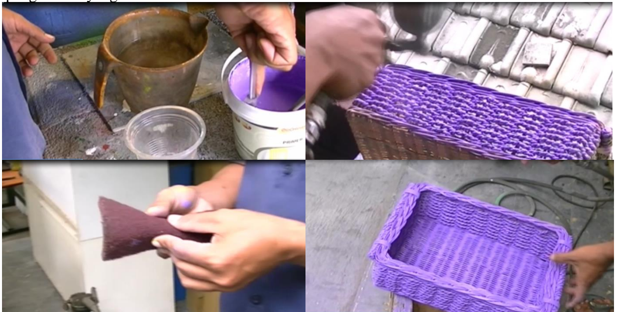
Gambar 8. Pelatihan teknik pengecatan non toxic water based finish pada keranjang rotan
