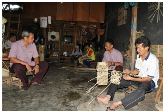
Gambar 6. Teknik anyaman menggunakan rangka besi
