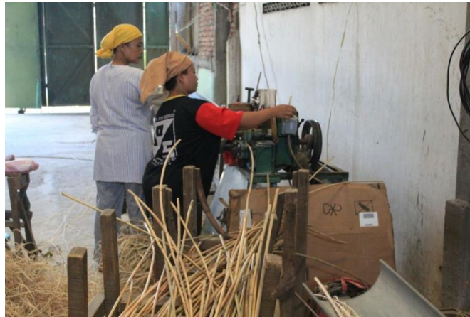
Gambar 4. Teknik serut bahan rotan utuh menjadi rotan belah
