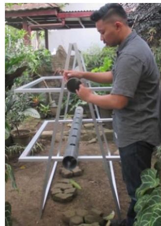
Gambar 6. Pemotongan, pelubangan pipa PVC, dan perakitan
