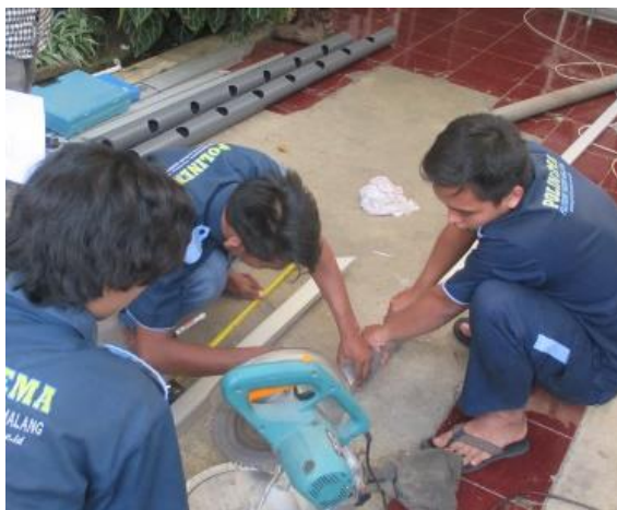
Gambar 6. Pemotongan, pelubangan pipa PVC, dan perakitan
