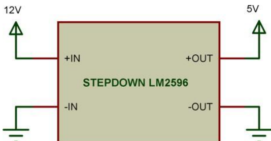
Fig. 3. Step-down module circuit
