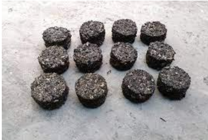
Gambar 4. Briket setelah dicetak dan dikeringkan
