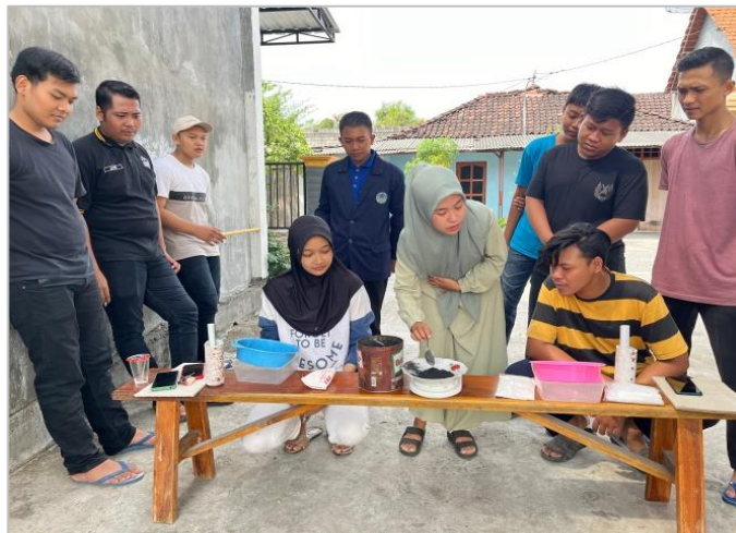
Gambar 3. Proses pencampuran arang dan lem kanji
