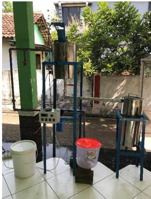
**Gambar 3.** Mesin konversi biodiesel dari minyak biji kapuk
