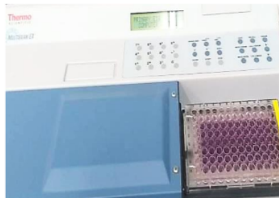
Gambar 6. Hasil MTT Assay pada kultur sel fibroblas dilakukan pembacaan dengan Elisa Reader.
