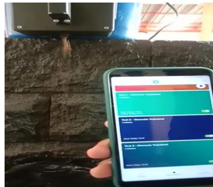
Gambar 1. 5 Alat Pakan Otomatis Mengeluarkan Pakan Sesuai Jadwal
