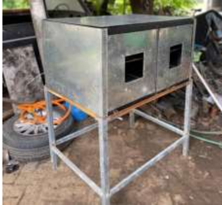
Gambar 4. Hasil Akhir Fabrikasi Oven FINICK
