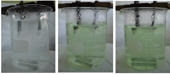
Gambar 1. Perubahan warna larutan selama proses elektrolisis pada sintesis nickel nanopartikel
